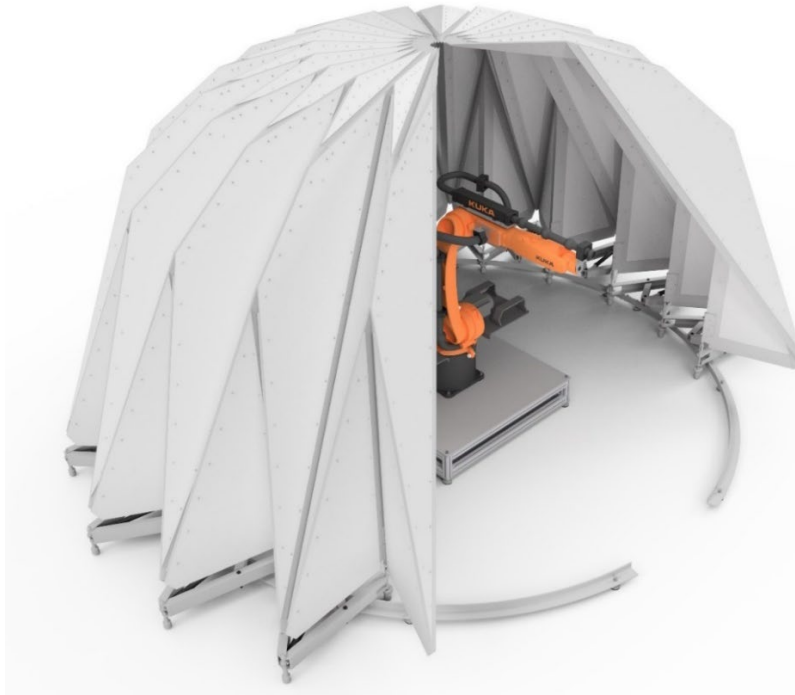
Bild 1: Konzeptskizze der wandelbaren Maschineneinhausung am Beispiel eines Industrieroboters (Kuka Roboter Modell: KR 10 R1420)
